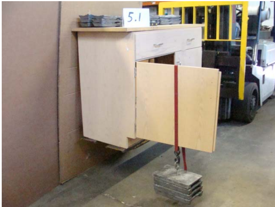
Photo 5: 5.1 Door Hinge Test
